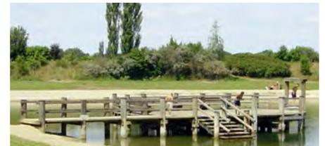
Nach einer behördlichen Überprüfung und einem Sachverständigen-gutachten musste der Steg im Au-Bad gesperrt werden. Die Tragfähigkeit war nicht mehr gegeben, was eine Sanierung im heurigen Jahr nach sich zieht.
